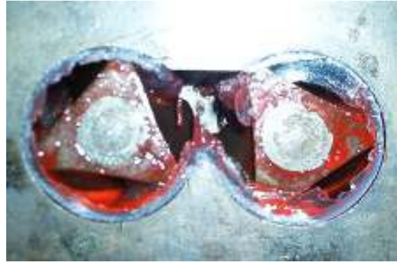
Figure II-16 : Injection de l'ε-CL, chute du couple
