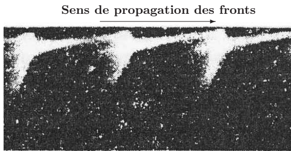
FIG. 2.12 – Visualisation par fente de trois fronts de détonation successifs ( C_2H_2/O_2 , \varnothing = 4 ) [11]
