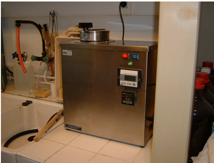
Figure 3-6. Appareil pour la détermination des constituants pariétaux (Fibersac).
