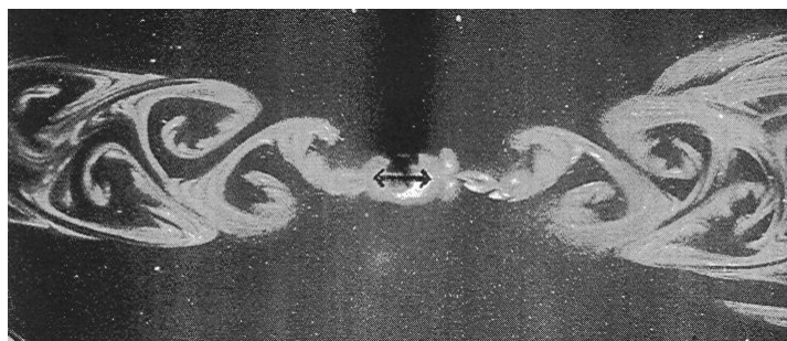
FIG. 1.4 – Détachement tourbillonnaire à \beta = 42 pour KC = 4.4 - Régime C (d'après TATSUNO & BEARMAN (1990)).
