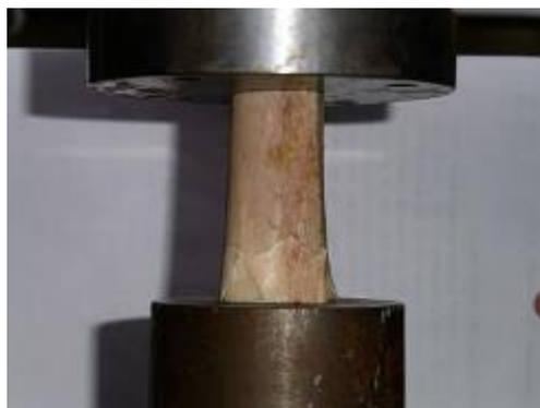
**Figure 3.16 :** *Essai quasistatique en compression qui a mené l'échantillon de diaphyse fémorale humaine à rupture. On observe de la délamination sur le bas de l'échantillon.*
