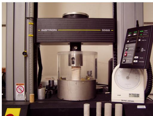
**Figure 3.2 :** Echantillon d'os bovin lors d'un essai de fatigue en compression dans la machine d'essai INSTRON 5569.
