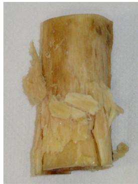
**Figure 3.23 :** *Echantillon arrivé à rupture après 4 étapes d'endommagement.*
