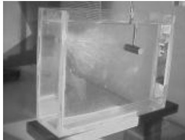
Fig. 3.5. Cuve en plexiglas utilisée pour les expériences préliminaires. Dimensions 10 \times 40 \times 50 cm.
