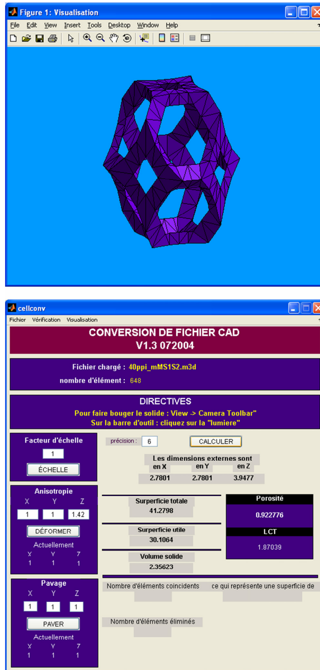
Figure 6.1 Configuration géométrique typique de microstructure idéalisée de mousse permettant de tester la convergence de la solution. En bas, porosité et longueur caractéristique thermique (LCT) sont obtenus par intégration spatiale des éléments de volume et de surface. En haut, la cellule périodique tridimensionnelle a la forme d'un tétrakaidécèdre, ses ligaments sont de section triangulaire, et le facteur d'anisotropie est de 1.42.
