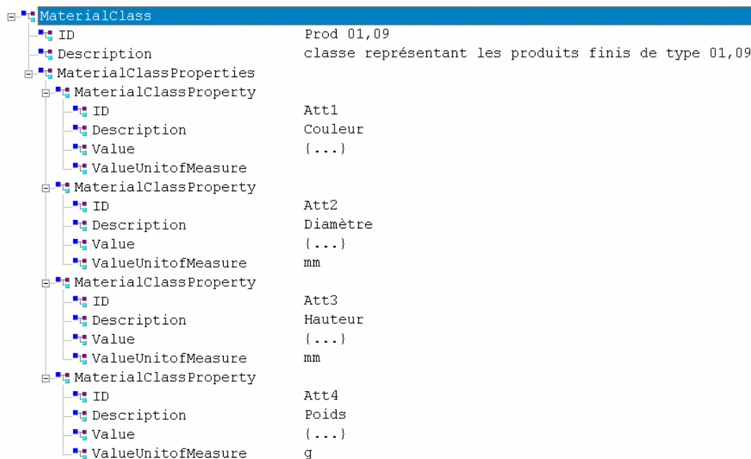
Figure 69. Instantiation des éléments MaterialClass et MaterialClassProperty correspondant à la classe du produit « Prod01,09 ».
