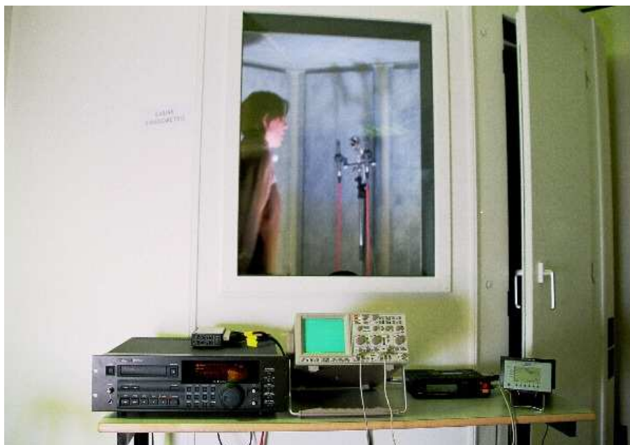
FIG. 6.1 – Chambre insonorisée utilisée pour les enregistrements et dispositif de mesure (enregistrement sur DAT et visualisation des signaux à l'oscilloscope).
