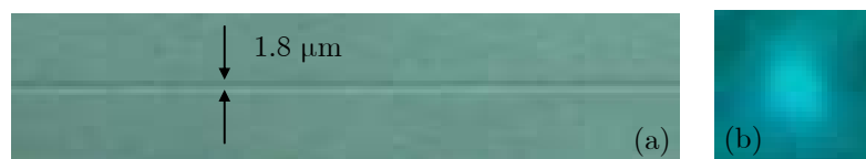
Figure 7.22 – Deux techniques de mesure du diamètre du guide : (a) en volume, (b) en surface.
