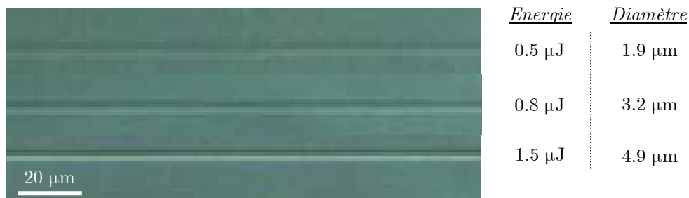
Figure 7.24 – Influence de l'énergie sur le diamètre des guides, à vitesse constante ( 20 \mu\text{m}/\text{s} , 1 passage)
