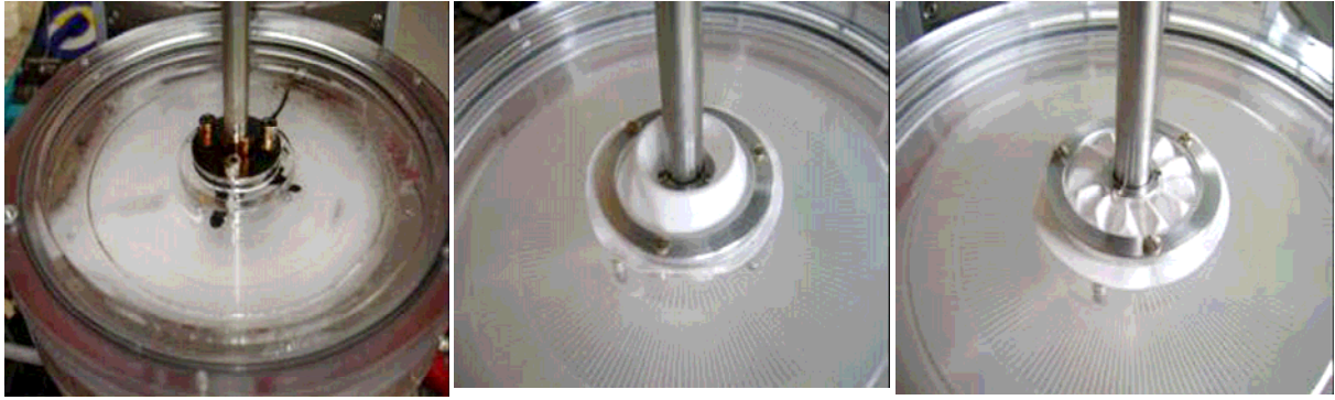
Figure 4.47 : de gauche à droite, joints déformables à base de ferrofluide et deux modèles en silicone
