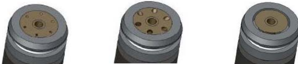
Figure 4.14 : bagues d'injection à trous ou à rainure (extraite d'un rapport de EADS-ST, 2004)
