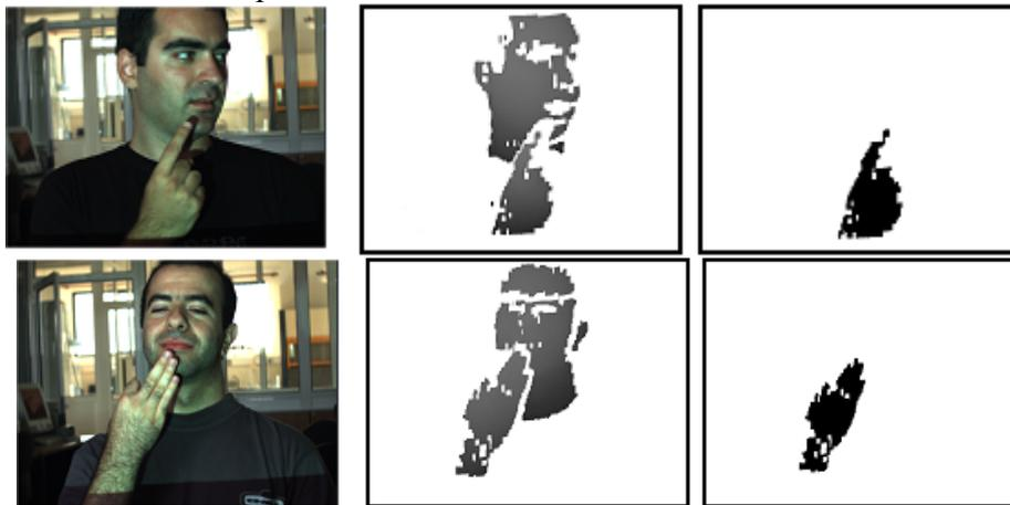
Figure 36 : à gauche, images couleur ; au milieu, cartes de profondeur ; à droite, mains segmentées.
