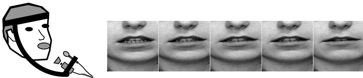
Figure 49 : à gauche : micro-caméra ; à droite : exemple de séquences d'images acquises par la micro-caméra.
