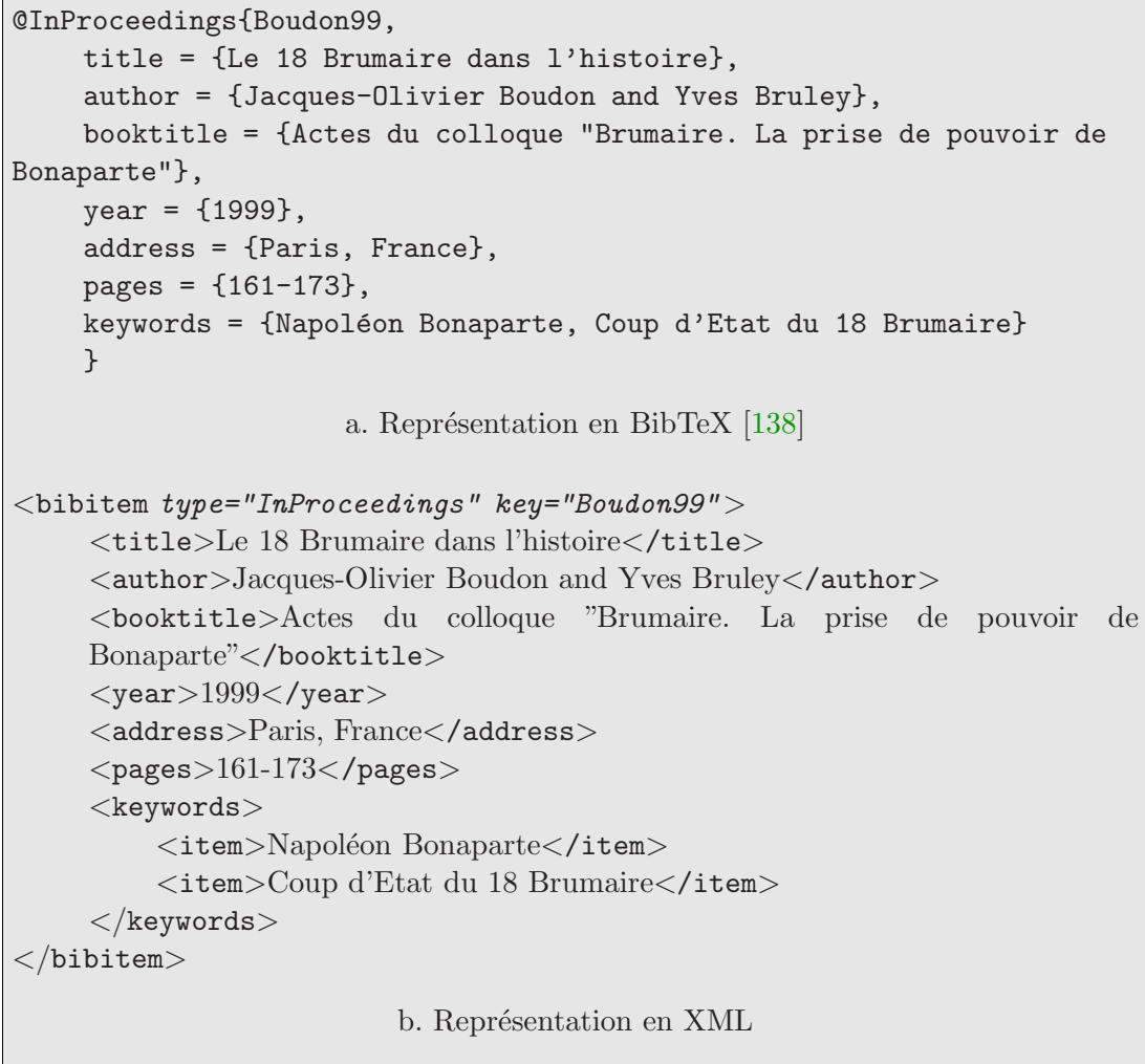
FIG. 1.4 – Représentation d’un élément bibliographique sous un format BibTeX (a.) ou XML (b.). On parle dans ce cas-là de document semi-structuré, car la structure n’est pas régulière; des champs peuvent être omis s’ils sont inconnus ou non pertinents (adresse, pages...), d’autres ont une certaine structure interne (par exemple, dans le champ author , les noms obéissent à une certaine grammaire et sont séparés par le mot réservé ‘and’). BibTeX permet aussi d’effectuer des références croisées. Les mots-clés ( keywords ) de la version XML contiennent un nombre de champs item indéterminé. Toutes ces caractéristiques rendraient inutilement complexe la description de ces informations par des bases de données [2]. Cet élément bibliographique est néanmoins orienté données , puisque la structure a autant d’importance que le contenu textuel.
