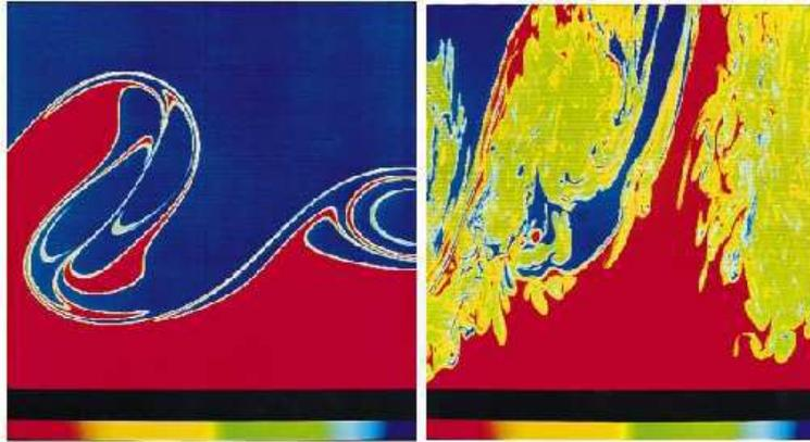
FIG. 2.11 – Champ scalaire dans une couche de mélange pour  $Re(x) = 1,75 \times 10^3$  (à gauche) et  $Re(x) = 2,3 \times 10^4$  (à droite). D'après Koochesfahani et Dimotakis [81].
