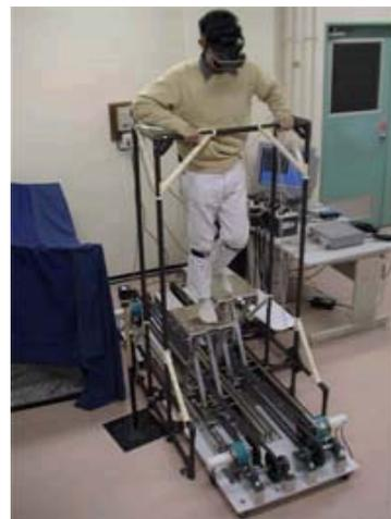
*Figure 10. GaitMaster type unidirectionnel*
