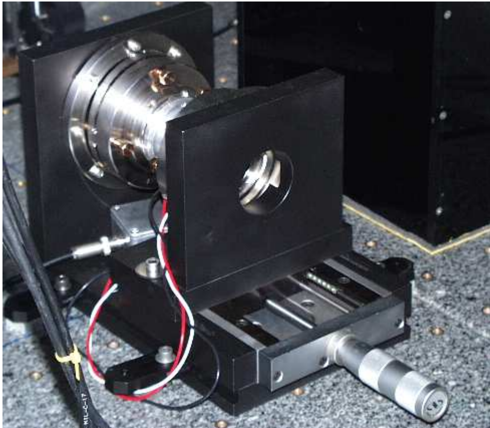
Figure 5-1 : Cavité Fabry-Perot réglable : un des miroirs est monté sur une platine de translation permettant de modifier la distance entre les deux miroirs, donc l'intervalle spectral libre.
