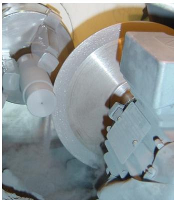
FIG. 1.1 – Tronçonnage après tournage
