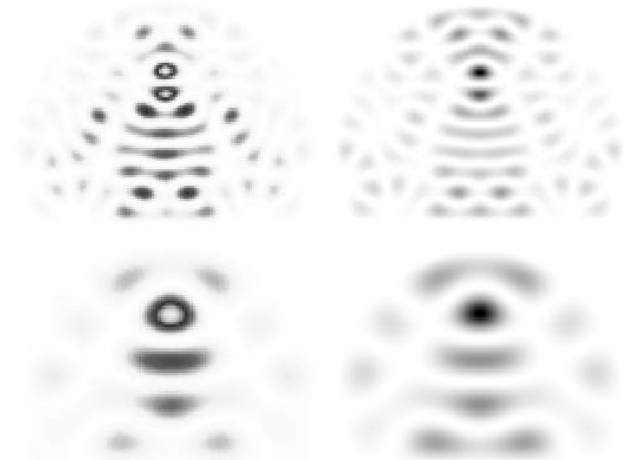
FIG. 9 À gauche : images de champ proche obtenues par transformée de Fourier inverses après filtrage du champ lointain par un anneau centré en k_t R = 23.5 (en haut) et k_t R = 10.9 (en bas) : à droite les modes scars p = 10 et p = 4 calculés dans une cavité métallique.
