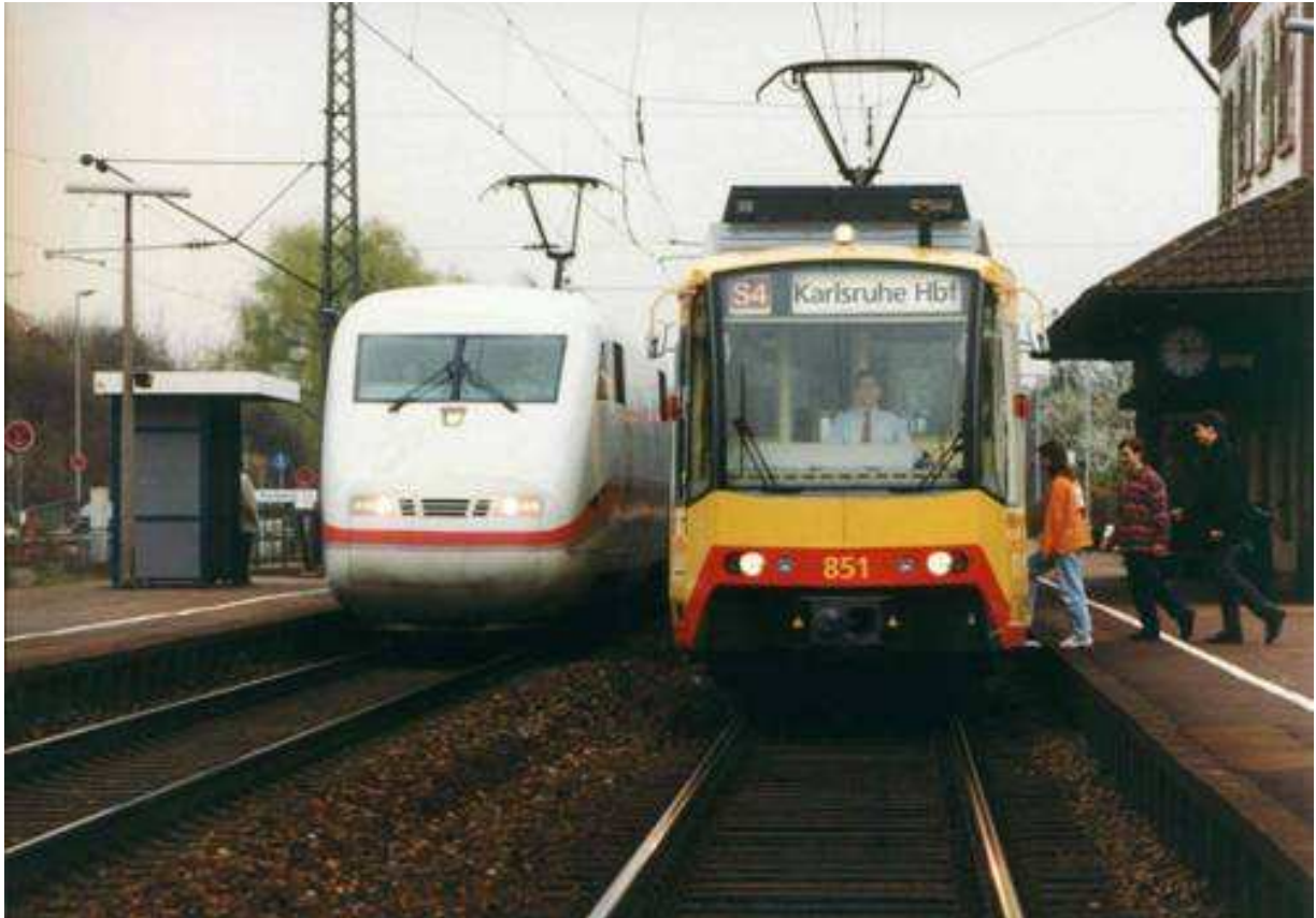
Figure 4-1. Tram-train et Train en gare de Karlsruhe sur le réseau ferroviaire principal (source TTK)
