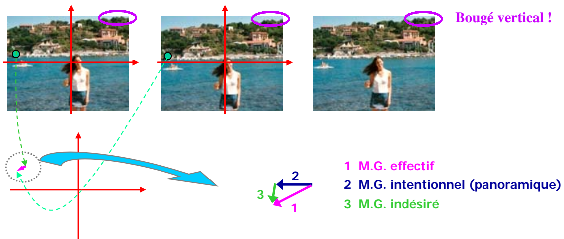
Figure II.2. Extrait d'une vidéo panoramique horizontale, avec bougé vertical lors de l'acquisition de la 2 ème image.
