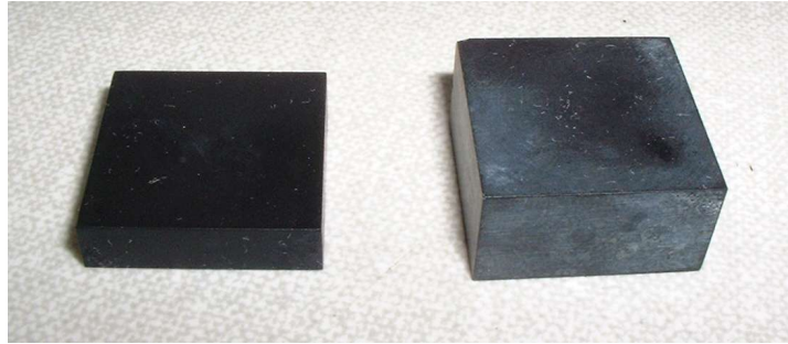
Figure 41 : les deux pastilles de Bi-2212 utilisées
