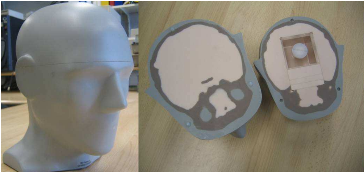
Figure IV.18 Fantôme tête anthropomorphe. A gauche, vue du fantôme fermé. A droite, vue ouverte où la cavité est comblée par une boîte cubique de PMMA qui peut être remplie de gel radiosensible et de cales.
