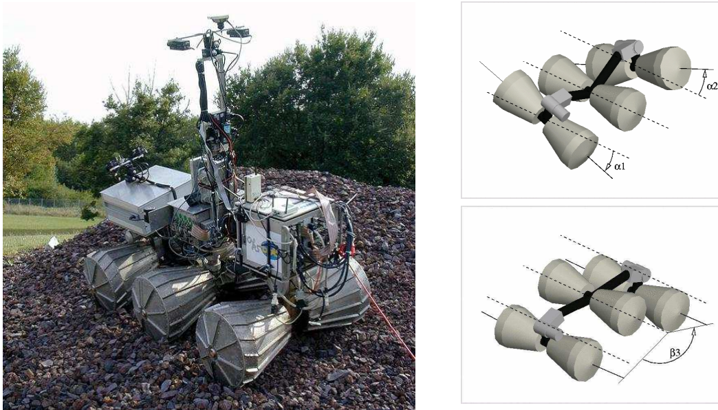
FIG. 3.2 – Le robot Lama et son châssis articulé
