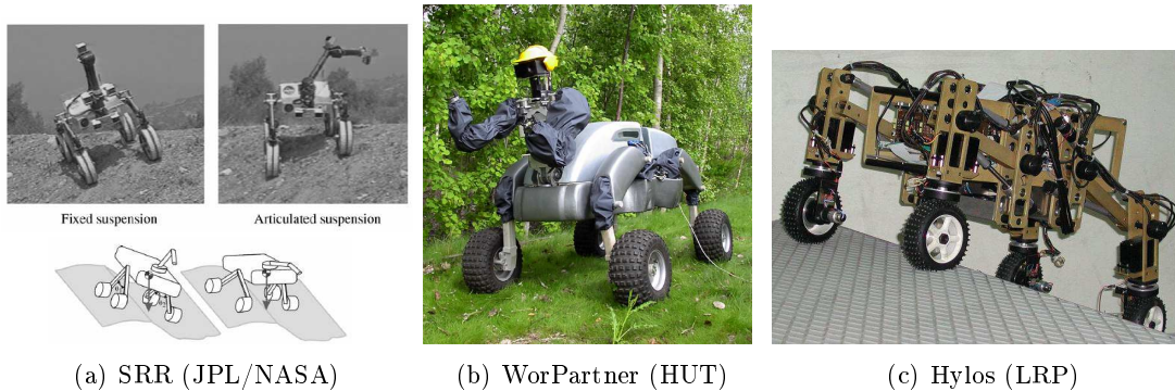
FIG. 1.6 – Plates-formes à mobilités internes actives
