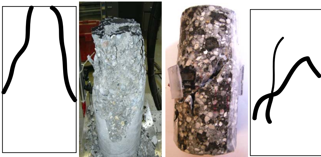
FIG. 4.15 – Faciès de rupture d'un essai de compression simple (à gauche) et de l'essai d'extension (à droite)
