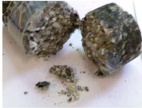
FIG. 4.11 – Ruine de la matrice, déchaussement des granulats au niveau des bandes de localisation
