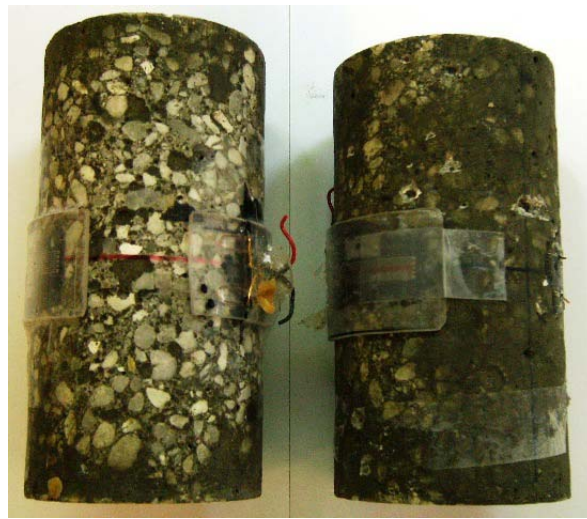
FIG. 4.9 – Faciès des essais hydrostatiques (à gauche) et PRP05 (à droite)
