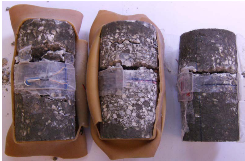
FIG. 4.10 – Faciès des essais TRX650, TRX200 et PRP03 (de gauche à droite)
