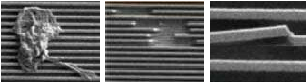
FIG. 1.3 – Exemple de tranche nettoyée après une étape de gravure dans l'oxyde. Des résidus de gravure (polymères) restent après un strip standard. En complément, une étape scrubber a été réalisée pour éliminer ces résidus de résine. Après cette étape, des résidus peuvent rester présents sur la surface et les structures sont endommagées. Paradoxalement, dans cette situation, les étapes de nettoyage augmentent la défektivité.
