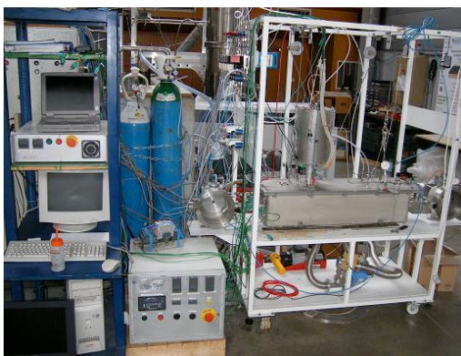
Figure 1-10 : photo et schéma de principe du dispositif MOCVD installé au CRETA.
