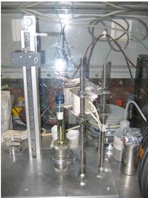
Figure 2-8 : photo et schéma de principe du procédé de dépôt par trempage.
