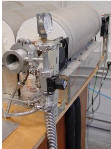
Figure 2-5 : four de recuit, avec le dispositif de pompage et de refroidissement.
