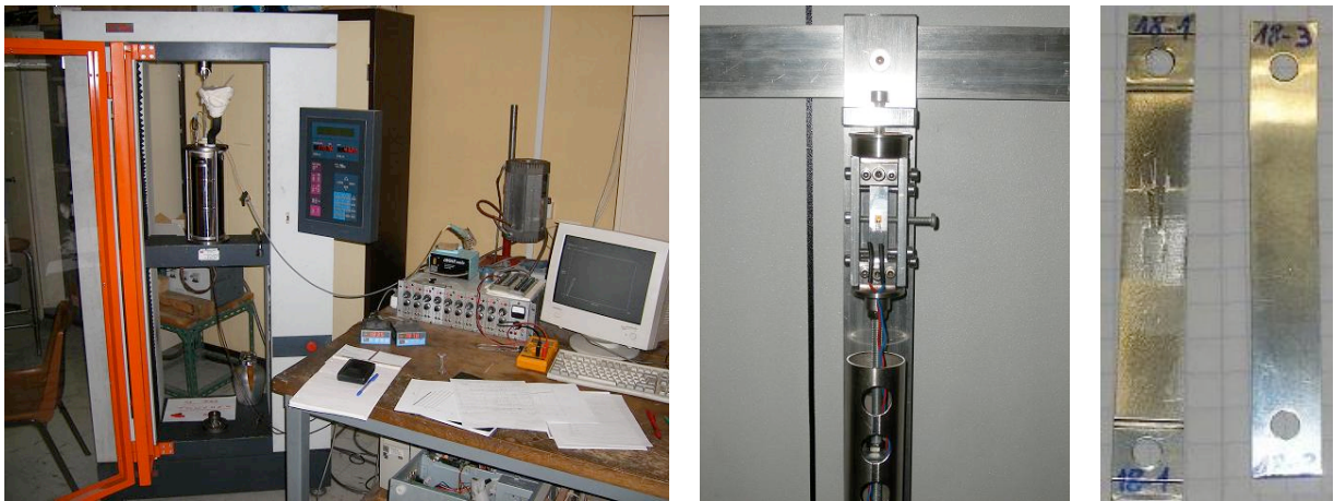
Figure 2-26 : photo du dispositif de traction, détail du porte-échantillon et éprouvette avant et après traction
