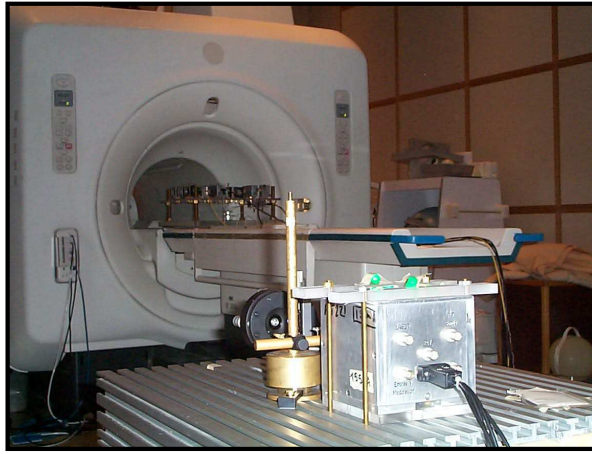
FIG. 5.6 – Vue d'ensemble. Les lasers (dont la diode sonde au premier plan), les appareils électroniques et le système d'acquisition informatique restent dans une région de faible champ magnétique.
