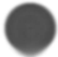
FIG. 6.2 – Fantôme informatique constitué d'un cylindre homogène. La reconstruction montrée ici est calculée à partir de 48 projections acquises sur un arc de 180^\circ et un diamètre d'ouverture du collimateur de 1,5 mm et démontre que la méthode EAR n'affecte pas le rendu de l'homogénéité.
