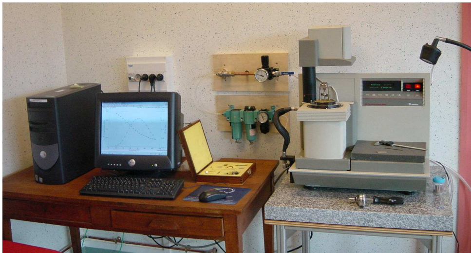
Figure IV- 7 : DMA utilisé pour les essais comparatifs
