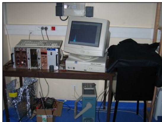
Figure III.18 : Image du dispositif expérimental utilisé au CERMEP-Animage (Lyon) pour les acquisitions de spectres photoélectroniques hors champ et dans l'IRM 7-T.
