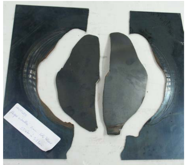
Figure 4.20 : Acier XC65-90 d'épaisseur 2 mm – détonation avec P_i = 1,2 bars.
