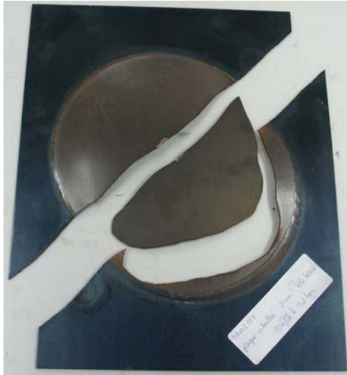
Figure 4.19 : Acier XC65-90 d'épaisseur 2 mm – déflagration avec P_i = 1,2 bars.
