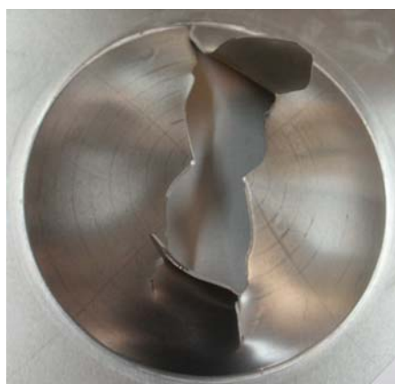
Figure 4.25 : Al2017 d'épaisseur 2 mm – détonation avec P_i = 1,6 bars.
