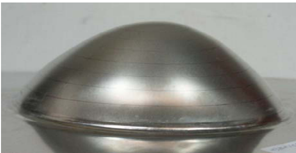
Figure 5.6 : Plaque fortement bombée après une détonation.
