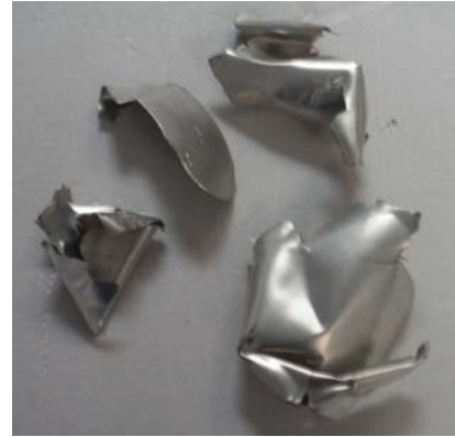
Figure 5.25 : Fragments éjectés (Al 2017) (0,5 mm) pour une détonation ( P_i = 1 bar).
