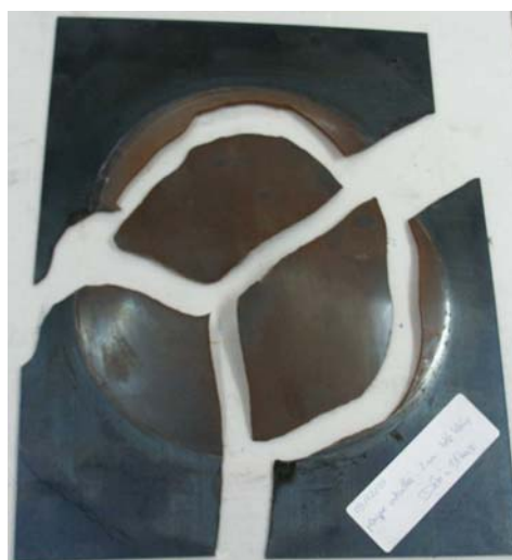
Figure 4.22 : Acier XC65-90 d'épaisseur 2 mm – détonation avec P_i = 1,6 bars.
