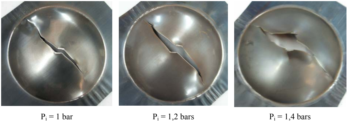
Figure 4.34 : Acier XC65-90 d'épaisseur 1 mm en déflagration.
