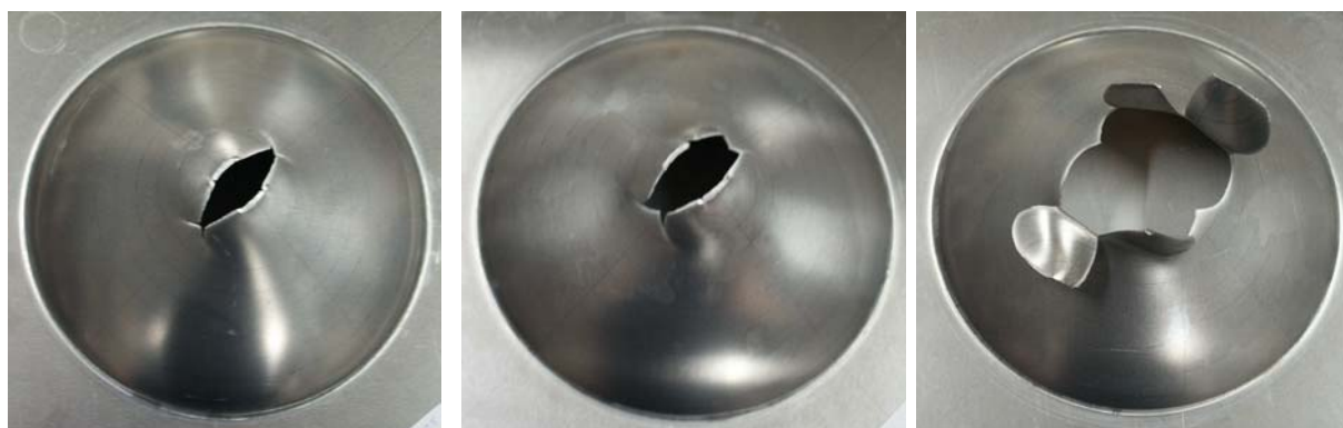
Figure 4.13 : Al5754 d'épaisseur 2 mm en déflagration.
