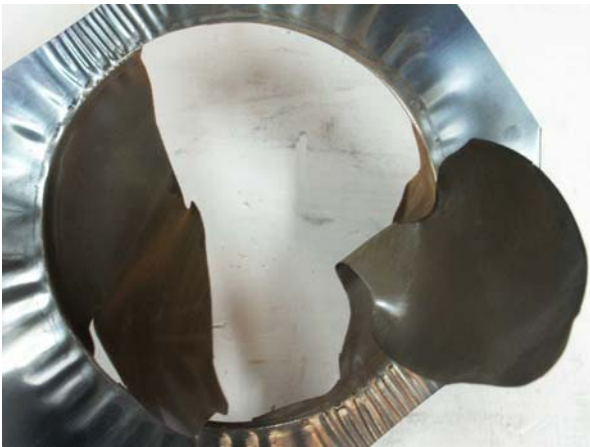
Figure 4.30 : Acier XC65-90 entaillé d'épaisseur 0,5 mm (détonation avec P_i = 0,8 bar).
