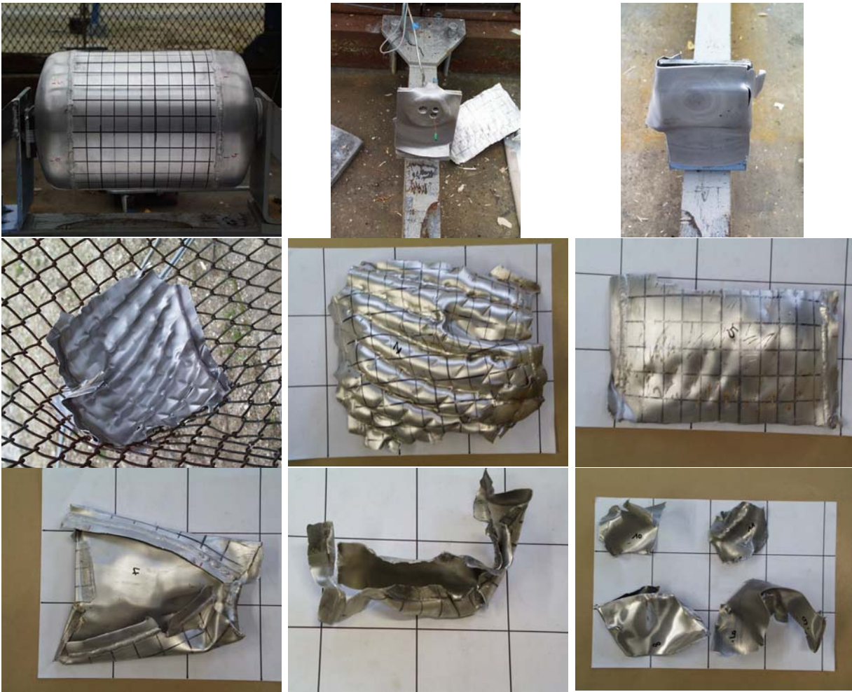
Figure A4.1 : Photographies du réservoir d'aluminium 5754 (essai n°2) avant et après l'essai.
