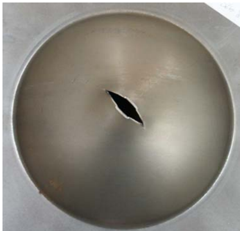
Figure 4.11 : Acier DC01 d'épaisseur 1 mm – détonation avec P_i = 1,6 bars.
