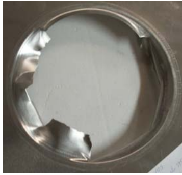
Figure 5.20 : Plaque rompue (Al 5754) (0,5 mm) pour une détonation ( P_i = 0,8 bar).
