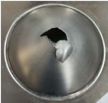
Figure 5.9 : Calotte formée (Al 5754) pour une détonation ( P_i = 1,2 bars) : 1 er essai.
