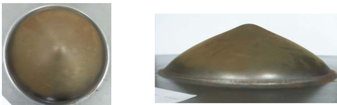
Figure 5.4 : Plaque d'acier DC01 d'épaisseur 0,8 mm – déflagration avec P_i = 1,6 bars.
