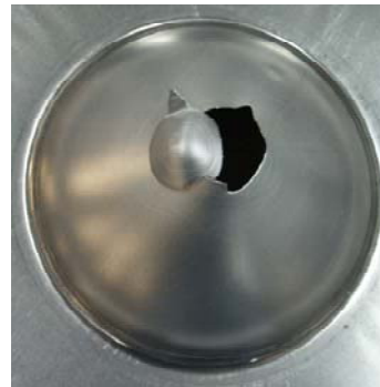
Figure 5.7 : Formation d'une calotte après une détonation.
