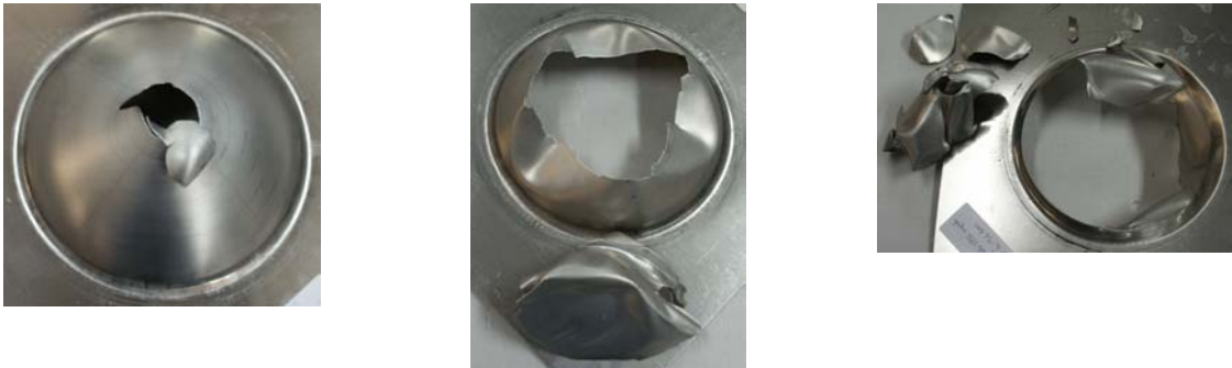
Figure IV.4 : Formation de calottes de différentes tailles (Al 5754 – 1mm – détonations avec des pressions initiales respectivement de 1,2 ; 1,3 et 1,4 bars).
