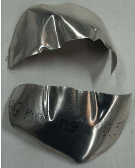
Figure 4.27 : Al 2017 d'épaisseur 0,5 mm - déflagration avec P_i = 0,8 \text{ bar} .
