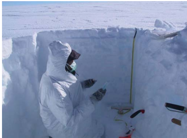
Fig. 2.3. Echantillonnage des signaux volcaniques de l'Agung et du Pinatubo à Dôme C
