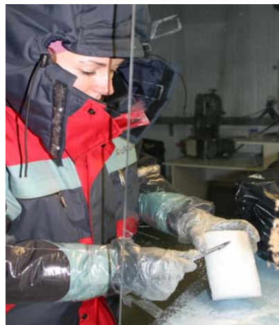
Fig. 2.7. Décontamination de la carotte de glace à l'aide d'un scalpel
