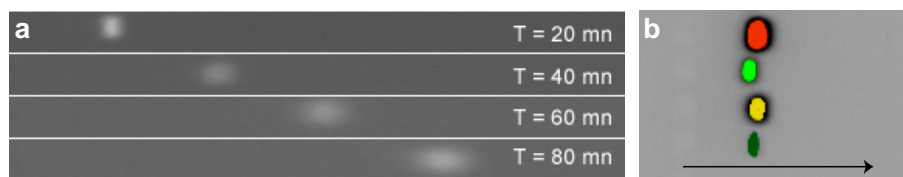
FIG. 14 – Migration de nanoparticules solubilisées au laboratoire avec de la cystéine dans un gel d'agarose (1%, TBE). a) déplacement au cours du temps pour un même échantillon, b) déplacement pour plusieurs échantillons correspondant à différentes couleurs d'émission.
