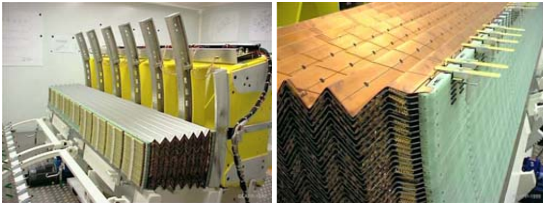
FIG. 3.14 – Photo du montage d'un module du calorimètre électromagnétique tonneau au LAPP et détails d'un module en construction.
