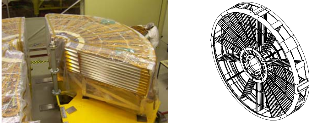
FIG. 3.12 – Photo lors de l’assemblage des modules d’un des bouchons du calorimètre électromagnétique (à gauche) et schéma de la roue externe et interne de ce même calorimètre avec seulement quelques absorbeurs (à droite).
