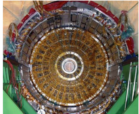
FIG. 2.17 – Vue du calorimètre électromagnétique bouchon à l'intérieur du cryostat C ( z < 0 ).
