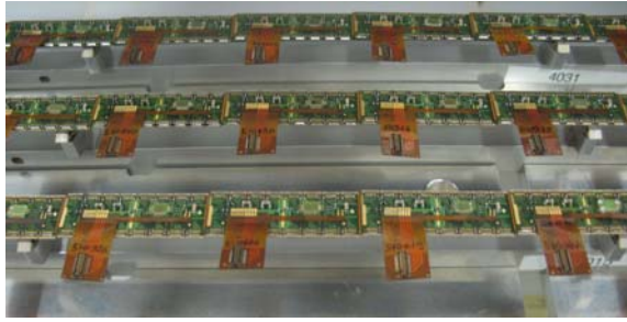
FIG. 2.4 – Échelles assemblées de modules de la partie tonneau du détecteur à pixels.
