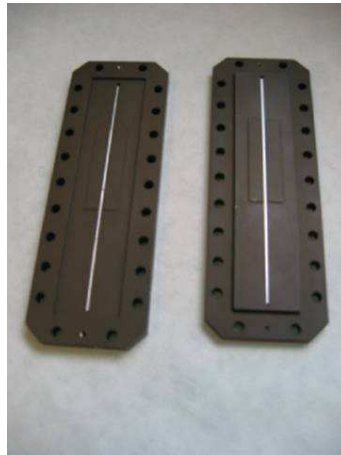
Figure I-2 : Plaques et canaux percés pour le transport du gaz réactif.
