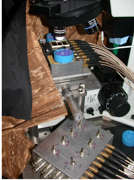
FIGURE 6.16: Mesure de conductance sur une surface "sèche". Il n'y a pas d'eau sur l'échantillon positionné sous l'objectif du microscope. L'échantillon est encadré par deux réservoirs contenant du gel de silice granulé. La mesure s'effectue à l'intérieur d'une cage en toile de cuivre finement tressée.
