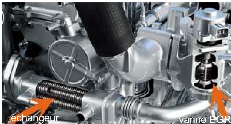
FIG. 1.7: Système d'EGR. (source : NISSAN)
