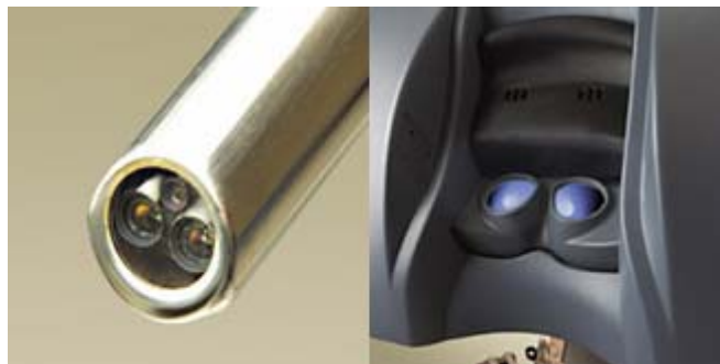
Figure 5-3 : Endoscope stéréoscopique du robot DA VINCI.
