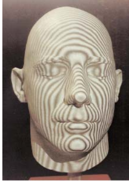
Figure 2-2 : Exemple de franges de moiré.
