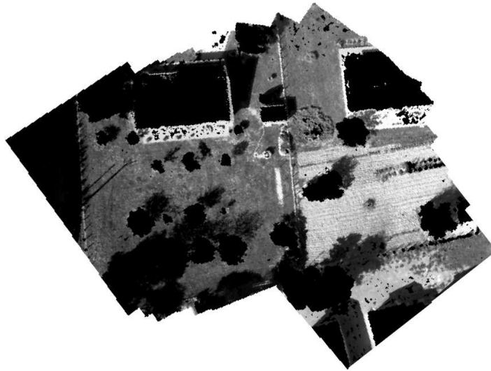
FIG. 2.4 – Détection de zones planes dans une séquence d'images aériennes (les obstacles sont représentés en noir). Cette mosaïque permet de construire incrémentalement une représentation probabiliste de la traversabilité pour un robot terrestres, qui sera à terme fusionnée avec le modèle de traversabilité présenté figure 1.15.
