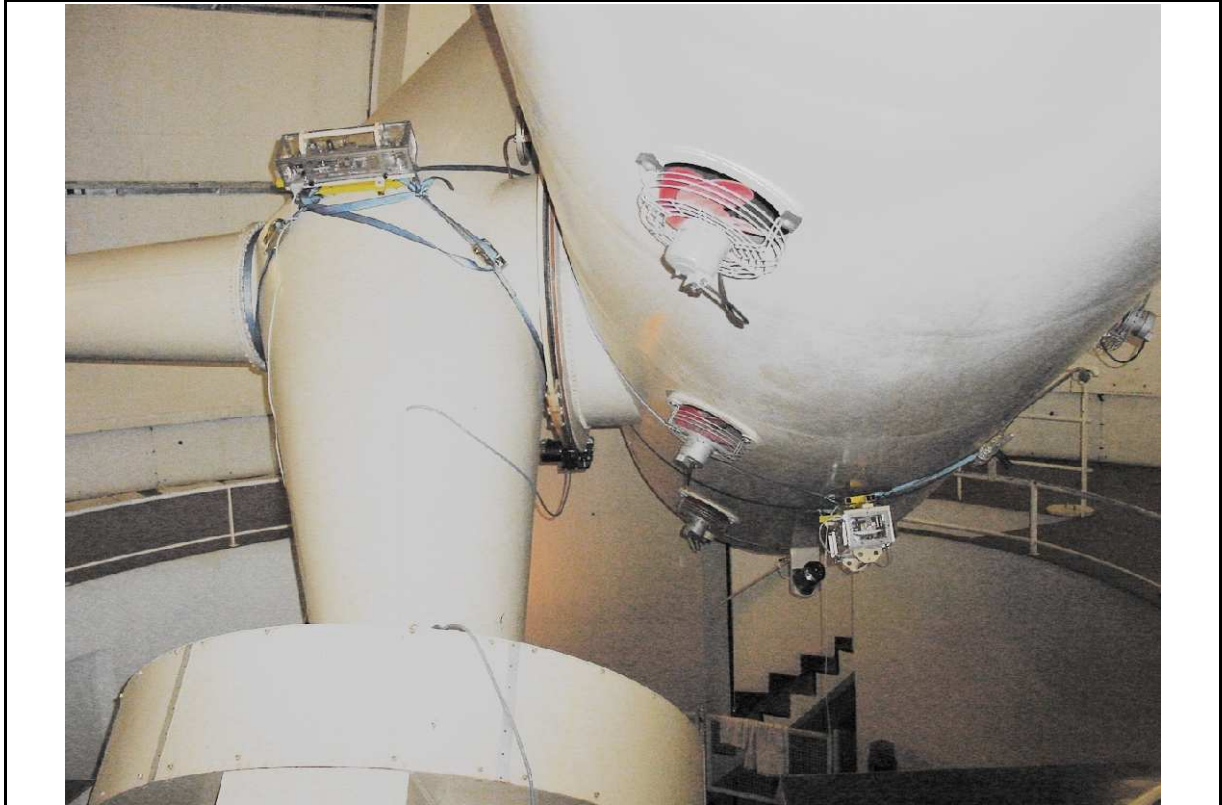
Figure IV.2 — Les deux sismomètres accrochés à leurs embases et sanglés sur le télescope 152 de l'OHP lors de ATTILA-I en Janvier 2003. A gauche, le sismomètre-2 placé sur l'axe du monde, mesure les perturbation liées à l'axe \alpha et à droite le sismomètre-1 est disposé sur le tube de façon à mesurer les mouvements parasites provenant de l'axe \delta .
