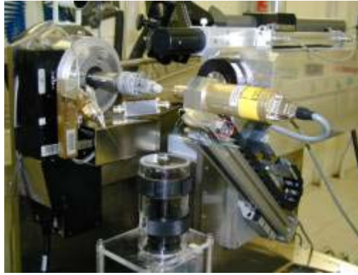
Figure 27) Exemple d'une ligne de lumière du Mocromolecular Crystallography Group : ID29 (dirigée par Dr Leonard G.) La ligne ID29 est dédiée à l'utilisation de la méthode MAD (« Multiple wavelength Anomalous Diffraction ») pour le phasage.
