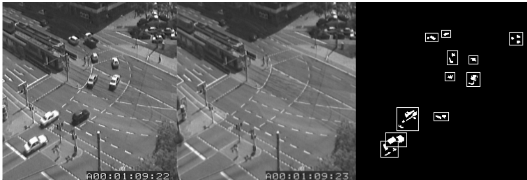
Fig. 5.3: Exemple de détection de mouvements d'objets avec l'application ICAM.
