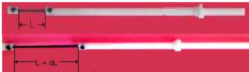
Figure 2-28 : Echantillon placé dans le porte-échantillon. A l'aide de la tige taraudée, l'expérimentateur peut choisir le taux d'extension de l'échantillon de caoutchouc
