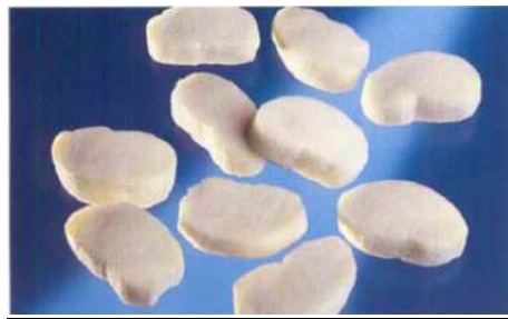
Figure 6-2 : morceaux de chloroprène non réticulé.
