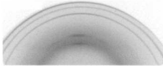
Figure 6-20 : Cliché de diffraction X d'un polybutadiène 1,4 cis tiré à \lambda=4
