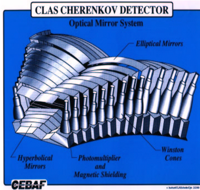
FIG. 2.16 – Vue en perspective des détecteurs Čerenkov (correspondant à un secteur de CLAS).
