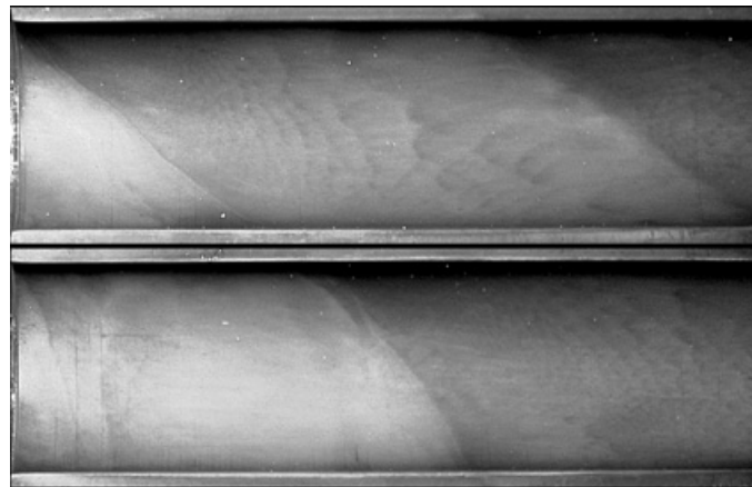
Figure IV.28 : Exemple de TDD dans un tube, section juste après la spire (obtenue pour \text{H}_2 -air)
