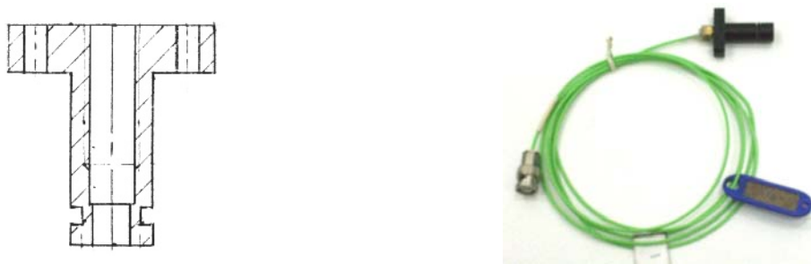
Figure III.13 : Schéma et photographie d'un support de capteur de pression
