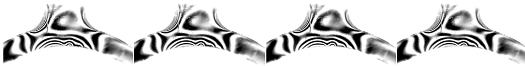
Figure III-17. Série de photos des champs d'isochromes dans la partie la plus chargée de la bielle, au moment de l'explosion, pour la bielle monobloc en PSM1.
