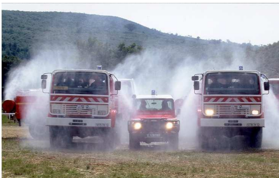
FIG. 2 – Camions de pompiers protégés par des sprays (CEREN Valabre)
