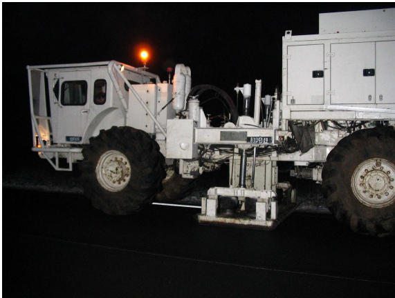
FIG. 1.1 – Camion vibreur pour l'acquisition sismique terrestre. FIG. 1.2 – Plaque vibrante du camion vibreur.
