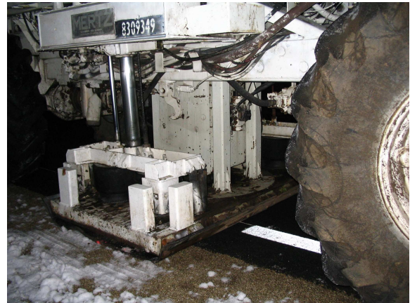
FIG. 1.1 – Camion vibreur pour l'acquisition sismique terrestre. FIG. 1.2 – Plaque vibrante du camion vibreur.
