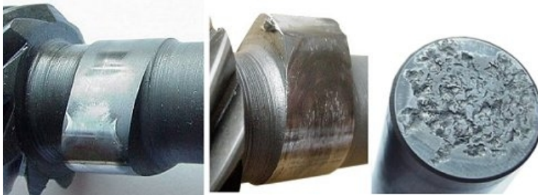
FIG. 2.22 – Photographie d'une usure par abrasion sur un arbre à came de distribution et présence d'adhésion son poussoir. [TRI]
