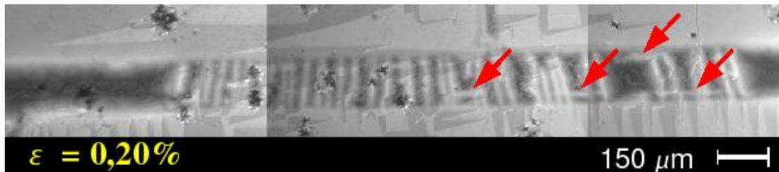
FIG. 5.18: image MO en Zero Field Cooled, sous 30mT, du même échantillon DyBCO, pour un allongement de 0,20%. Les flèches rouges indiquent les fissures horizontales de compression de la couche tampon de MgO.
