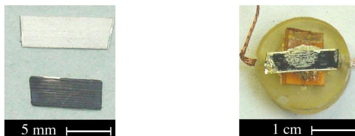
FIG. 3.9: **à gauche** : échantillon avec gaine d'argent (en haut), et après attaque de l'argent (en bas). **A droite** : échantillon dans la résine, après polissage.
