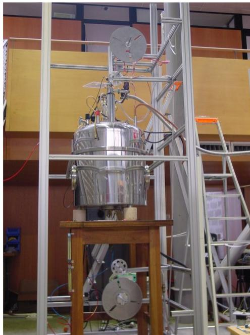
Dispositif de défilement de rubans Bi2212 sous champ magnétique.
